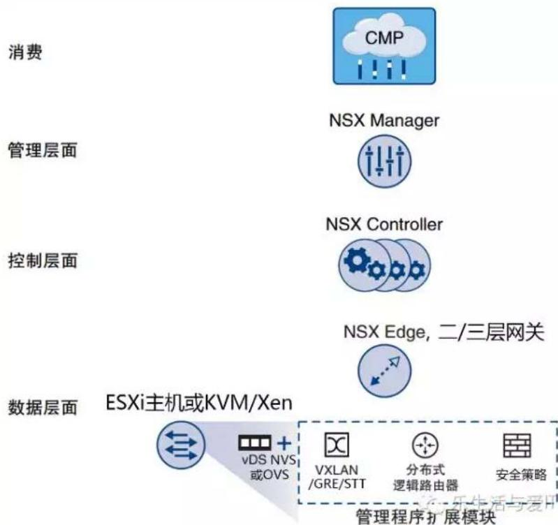
NSX 数据平面主要由 NSX 虚拟交换机组成。虚拟机交换机基于 vSphere 中的分布式交换机 (VDS)，或基于非 VMware 虚拟化环境中的 OVS (Open vSwitch)。通过将内核模块 (VIB) 安装在 Hypervisor 上，实现 VXLAN、分布式路由、分布式防火墙等服务。
