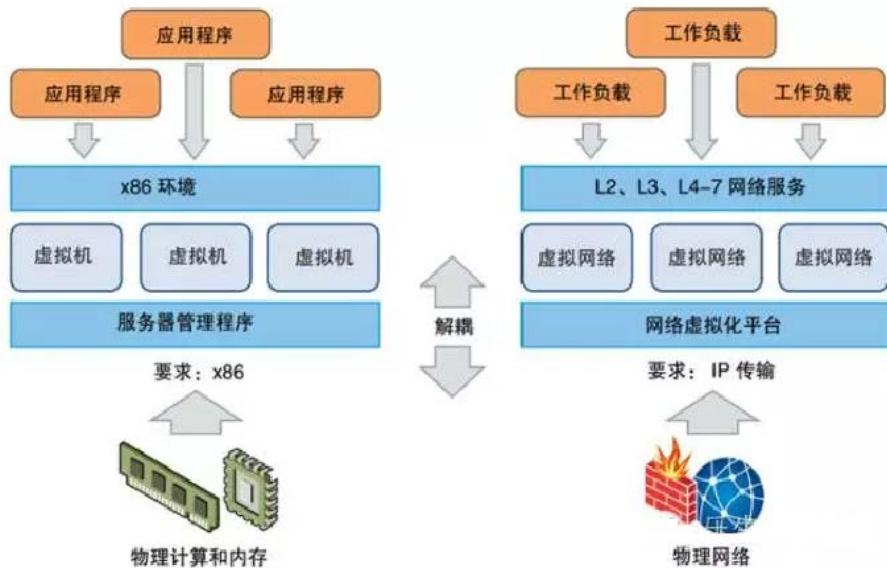
实现服务器虚拟化后，软件抽象层（服务器虚拟化管理程序 Hypervisor）可在软件中重现人们所熟悉的 x86 物理服务器属性，如 CPU、内存、磁盘、网卡，从而可通过编程方式以任意组合来组装这些属性，只需短短数秒，即可生成一台独一无二的虚拟机。而实现网络虚拟化后，与 Hypervisor 类似的“网络虚拟化管理程序”可在软件中重现二到七层的整套网络服务，如交换、路由、访问控制、防火墙、QoS、负载均衡。因此，与服务器虚拟化的理念相同，可以通过编程的方式以任意组合来部署这些服务，只需短短数秒，即可生成独一无二的虚拟网络（逻辑网络）。
